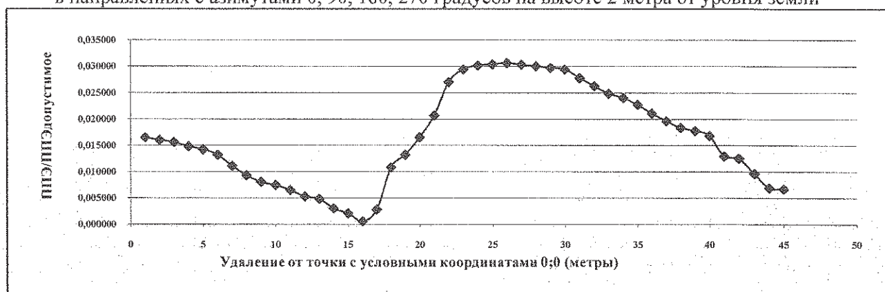
Величина ППЭ/ППЭдоп в азимутальном направлении от ПРТО от точки размещения антенны в направлениях с азимутами 0, 90, 180, 270 градусов на высоте 2 метра от уровня земли
