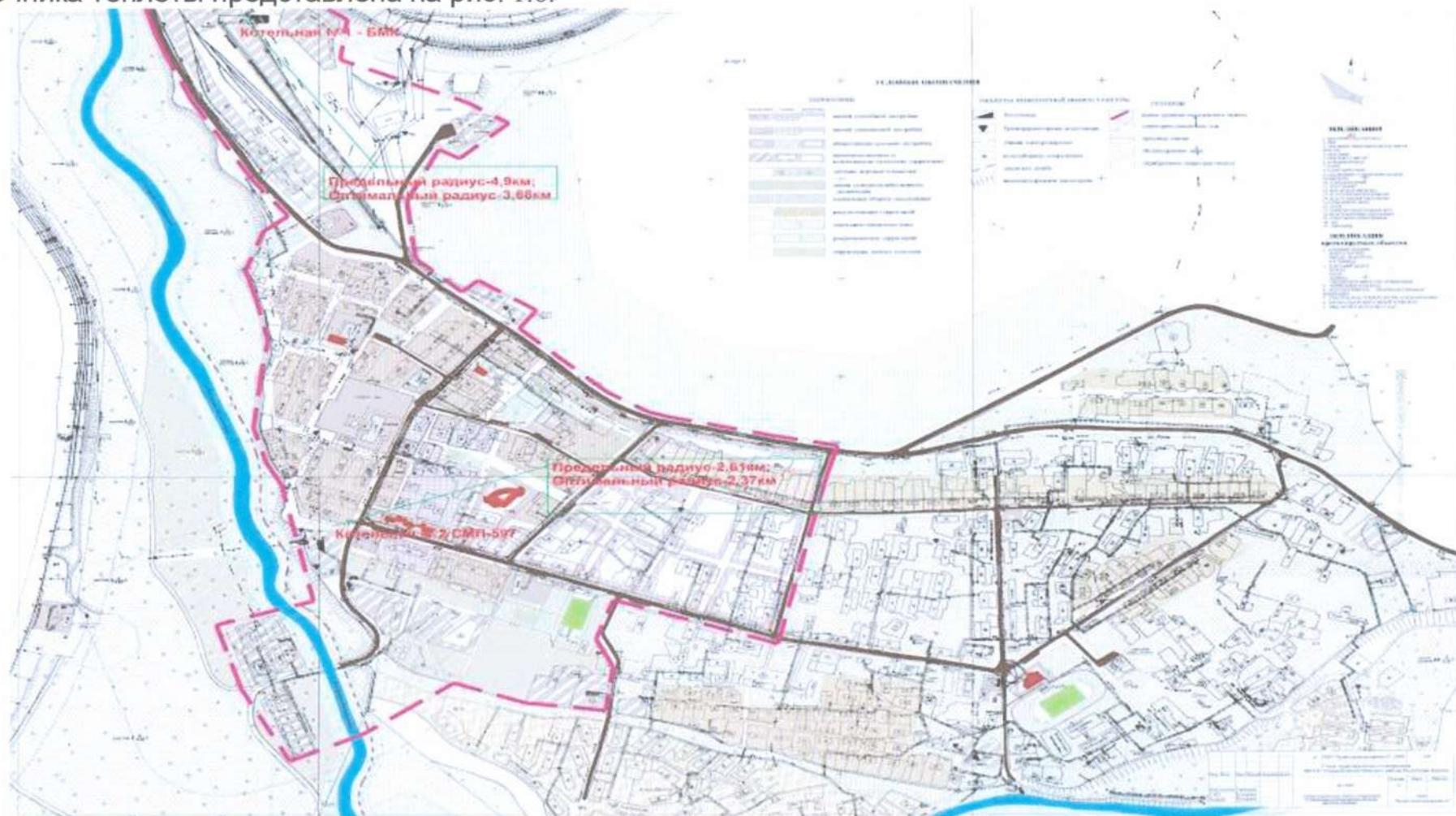
Рис . 1.6. Схема административного деления МО ГП «Северомуйское» с указанием расчетных элементов территориального деления (кадастровых кварталов) и радиусов эффективного теплоснабжения для каждого источника теплоты.
